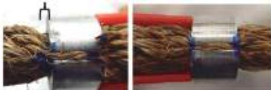
A la izquierda después de 1.500 ciclos, se observa una deformación plástica permanente en la abrazadera de presión sobre el peldaño por contacto con el grillete de prueba. Durante la prueba la abrazadera de presión se deslizó de 2 a 3 mm desde su posición inicial. A la derecha, tenemos la otra abrazadera de presión bajo el peldaño que como se observa no presenta deslizamiento alguno.
