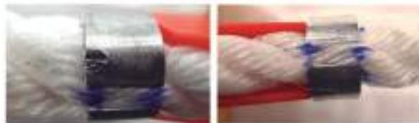
A la izquierda y después de 1.500 ciclos, observamos que el daño permanente en la parte superior de la abrazadera de presión es debido al contacto superior con el grillete de la prueba. La abrazadera de presión no se deslizó durante la prueba. A la derecha no se observa el deslizamiento en la abrazadera de presión.
