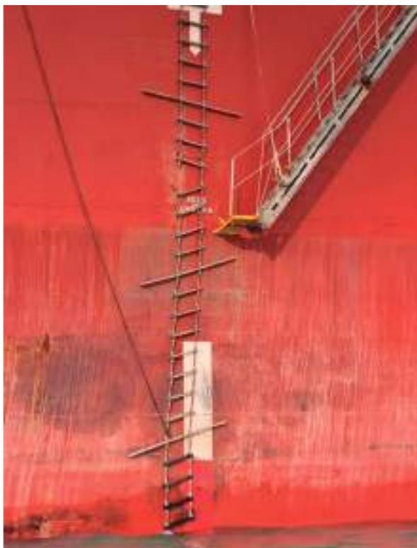
Fig.108: Escala o disposición combinada en mal estado.
