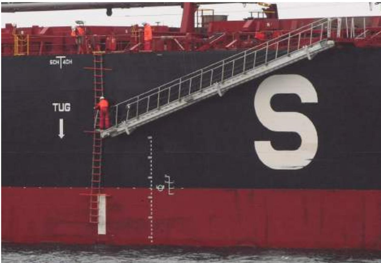
Fig. 70: Disposición o escala combinada (práctico y real) para un francobordo mayor de 9 metros.
