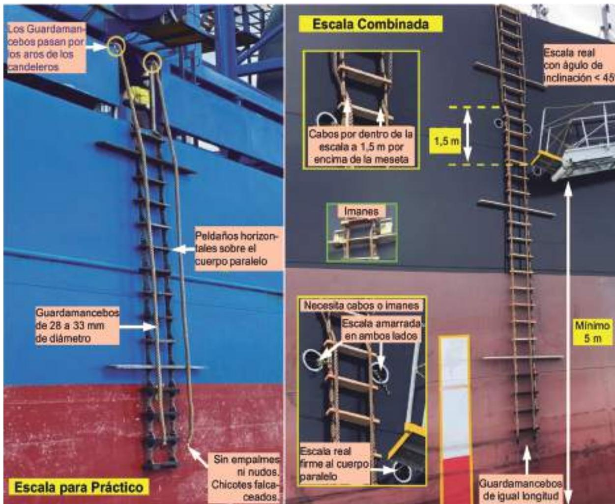
Fig. 38: Guardamancebos desplegados en la escala de práctico y en una disposición combinada. (Fuente: Port Authority of New South Wales).
