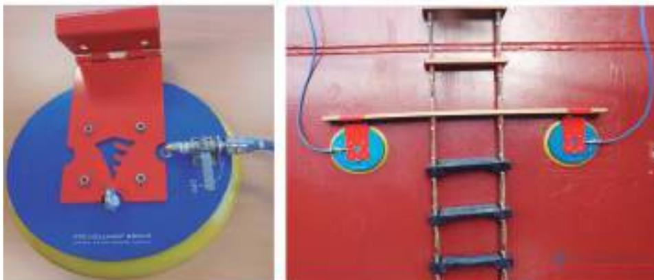
Fig. 44: Ventosa de succión neumática para escala de práctico.
