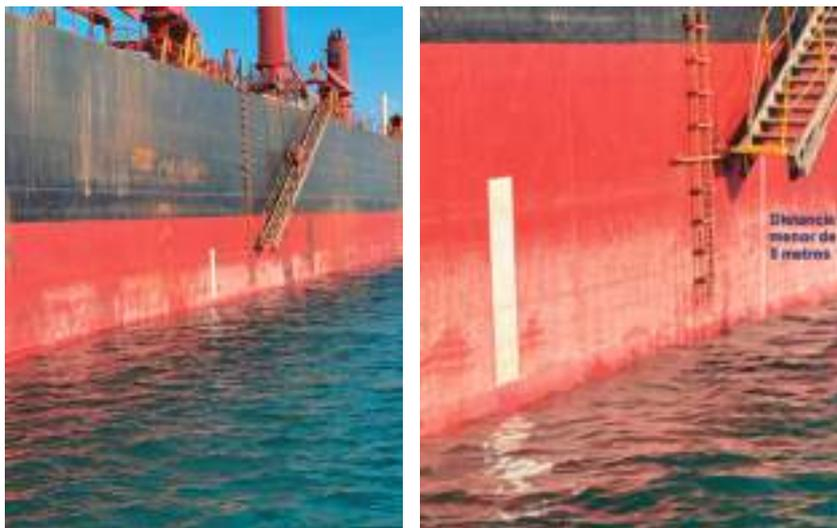
Fig. 78: Disposición incorrecta de la escala combinada, la distancia desde la meseta inferior a la mar es menor de 5 m. En las fotografías se observa como la disposición combinada cumple con la marca de 9 metros, pero implume el punto 10.1 de la norma ISO 799-3:2022 que hace referencia a la mínima distancia entre la superficie de la mar y la meseta inferior de la escala real.
