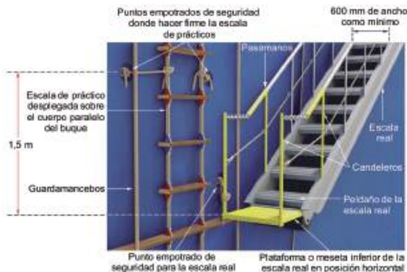
Fig. 73: Puntos notables en una disposición combinada. (Fuente: Fathom Safety)
