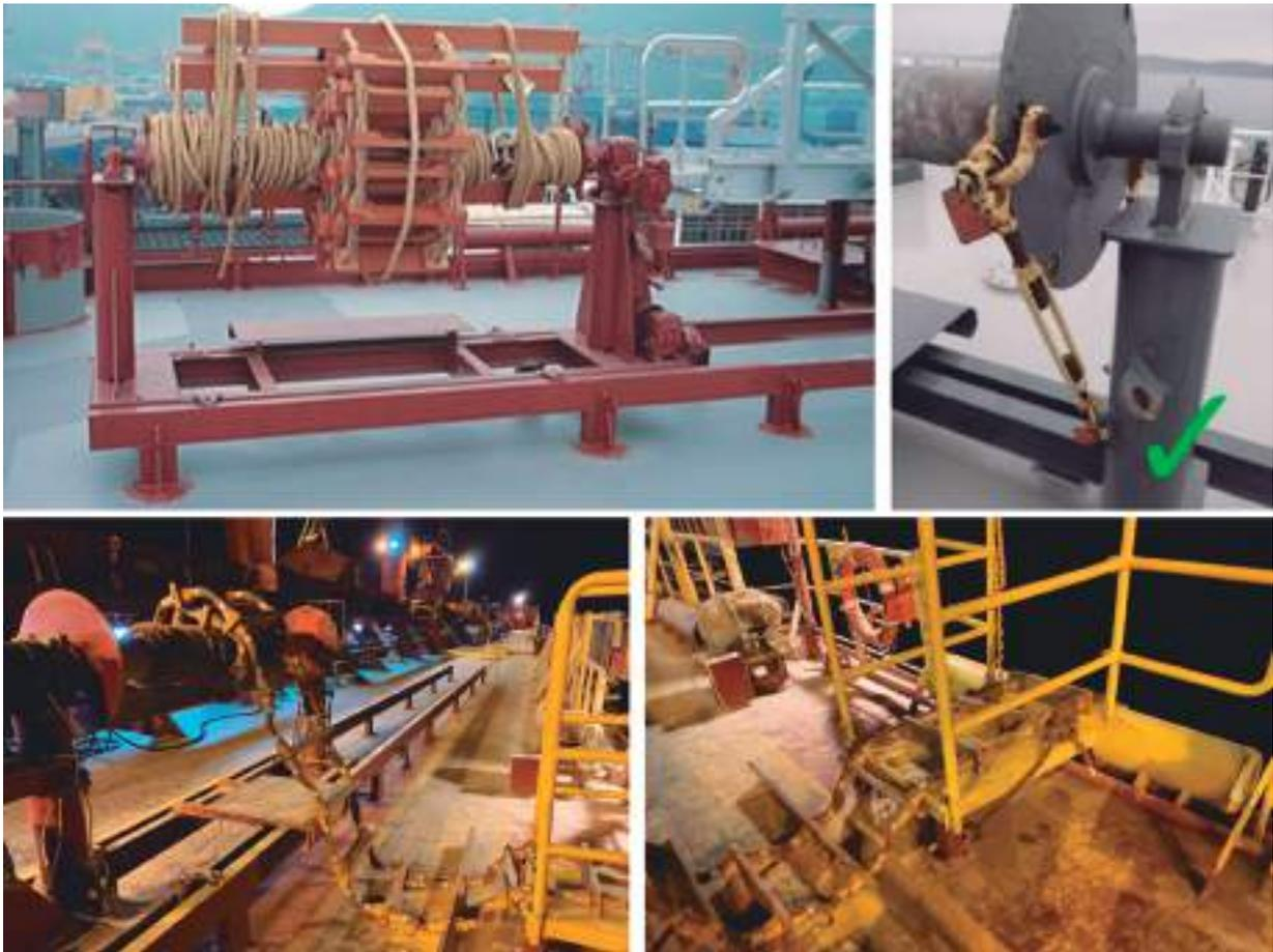
Fig. 68: Carretel de estiba con motor neumático, equipado con sistema de seguridad manual anti-giro.
