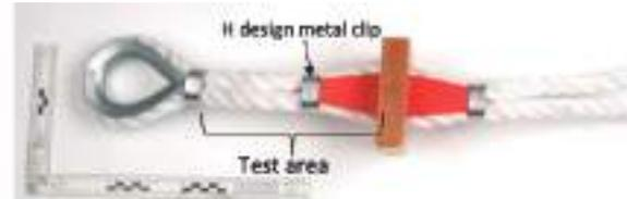
Cabo de polipropileno de 20 mm, con calzo de fijación de peldaño asegurado con abrazadera metálica de presión.
