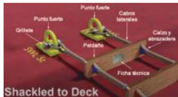
Fig. 37: Escala firme con grilletes a los puntos fuertes de cubierta.
