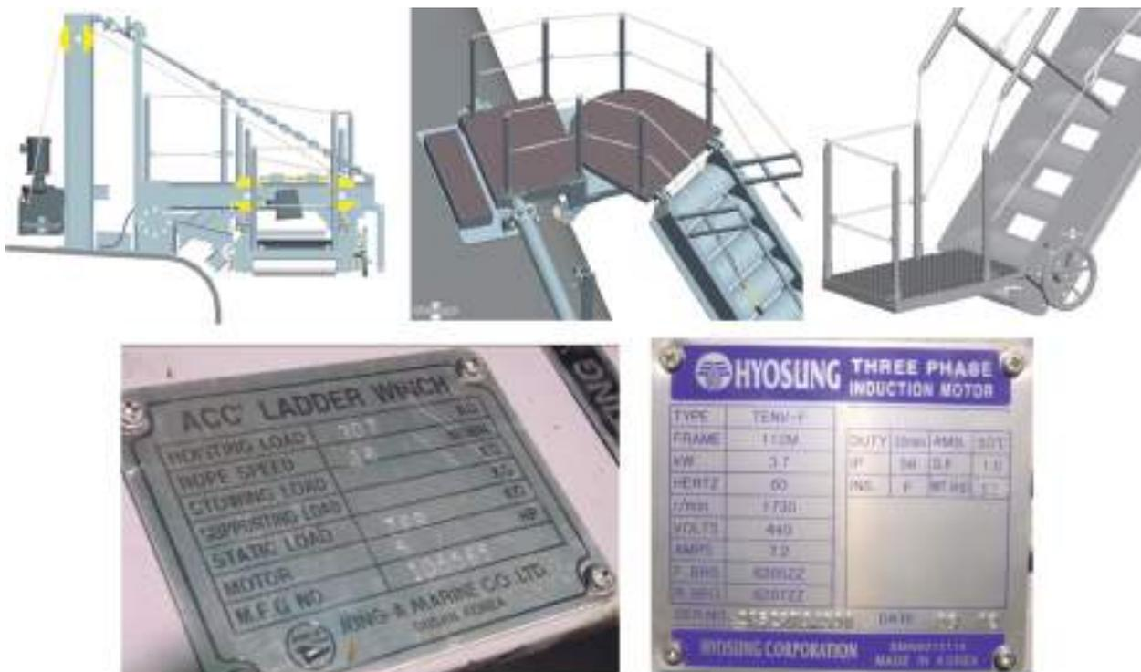
Fig. 84: Mesetas o plataformas superior e inferior de una escala real y chapas de identificación de la escala y su motor.
