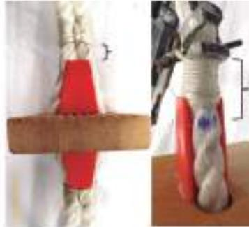
A la izquierda observamos el desplazamiento del peldaño, calzo y ligadura inferior. Se deslizaron hacia abajo aproximadamente 30 mm hasta que se impidió que se deslizará más abajo debido a la fuerza de la abrazadera.
