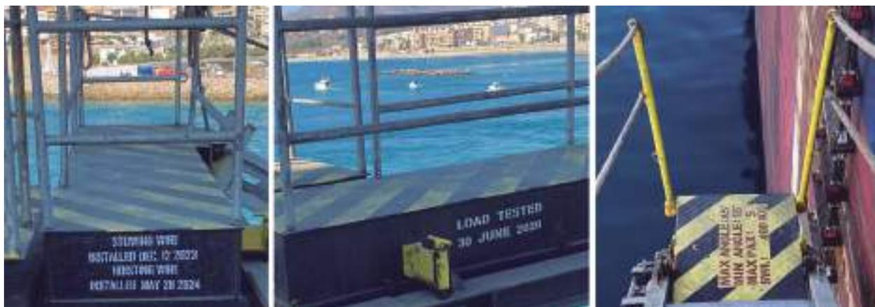
Fig. 74: Rotulado de los accesos desde la escala de práctico a la escala real y desde ésta a cubierta. (Fuente: Archivo fotográfico propio)
