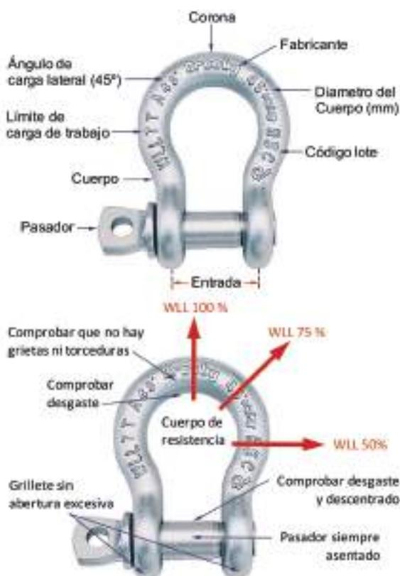
Fig. 36: Grilletes con perno o pasador roscado: partes y rotulado.
