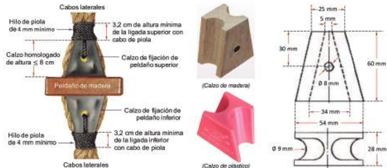
Fig. 28: Dimensiones de los calzos de fijación de peldaños.
