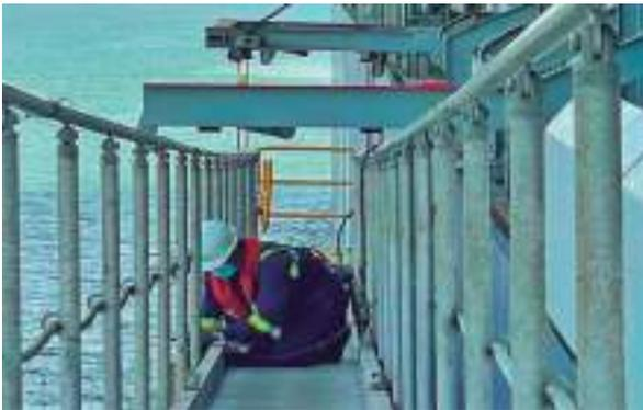
Fig. 79: Montaje de una escala real.
