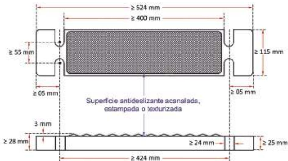
Fig. 9: Peldaño de sustitución no desmontable.
