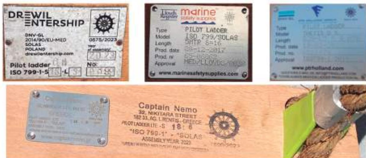
Fig. 86: Placas de identificación de la escala de práctico situadas en la cara opuesta a la de pisada.
