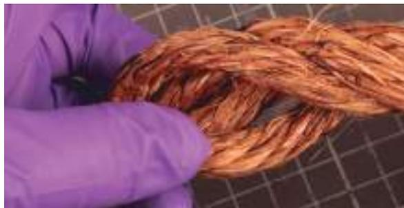
Fig. 17: Abacá o cabo Manila de 20 mm y 4 hilos.
