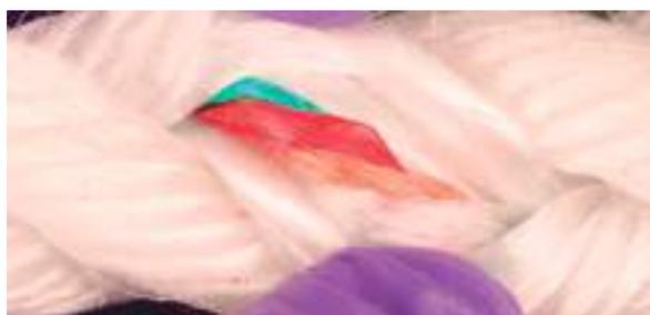
Fig. 18: Cabo de polipropileno de 20 mm y 3 hebras con tejido de núcleo interno.
