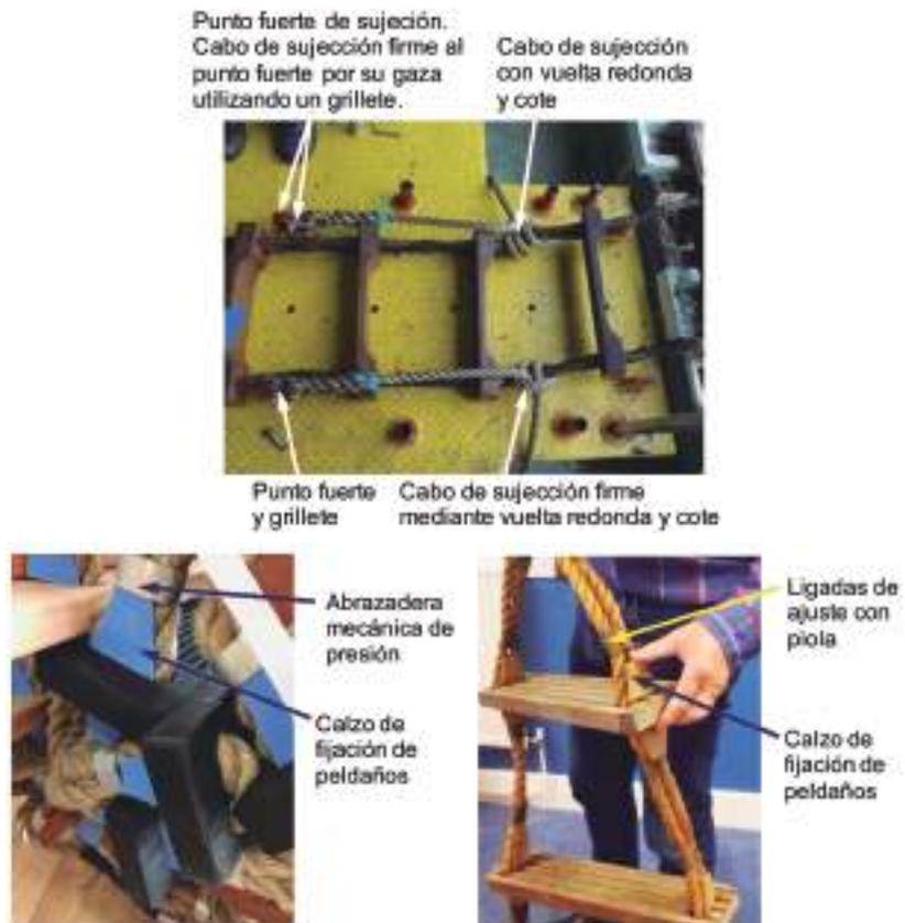
Fig. 90: En la parte superior, calzo de fijación de peldaño de madera firme mediante piola; en la parte inferior, fijación del peldaño mediante abrazadera mecánica de presión y calzo de fijación de peldaños. (Fuente: nC2 Engineering Consultancy)
