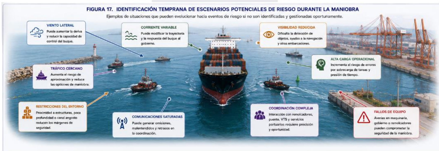
Figura 17. Identificación temprana de escenarios potenciales de riesgo durante la maniobra.
