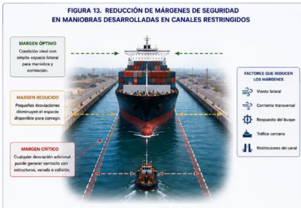
Figura 13. Reducción de márgenes de seguridad en maniobras desarrolladas en canales restringidos.
