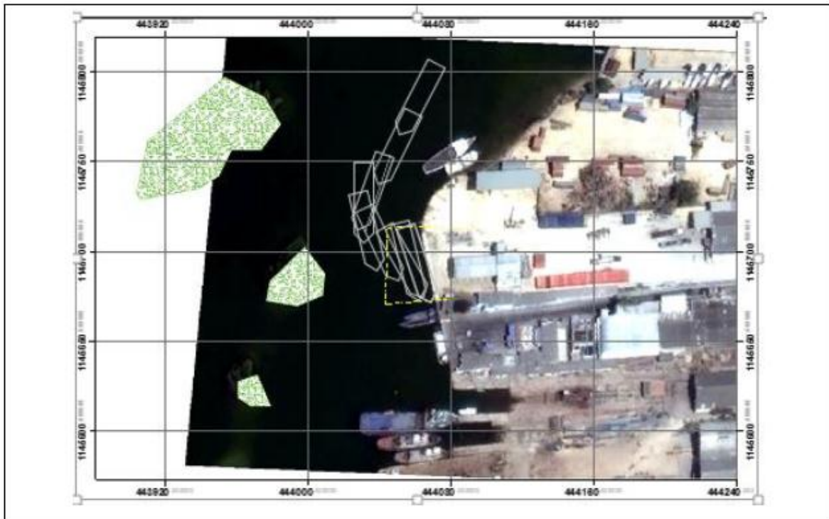
Ilustración 16 Descripción grafica de la maniobra de atraque, con aproximación desde el Canal Norte, sacado del PLAN DE MANIOBRABILIDAD OPERACIÓN PORTUARIA BITA R.M. S.A., y aprobado por la DIMAR.
