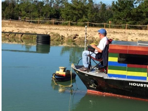
Figura 10: Remolcador a control remoto en maniobra (Fuente: González E. 2019)
