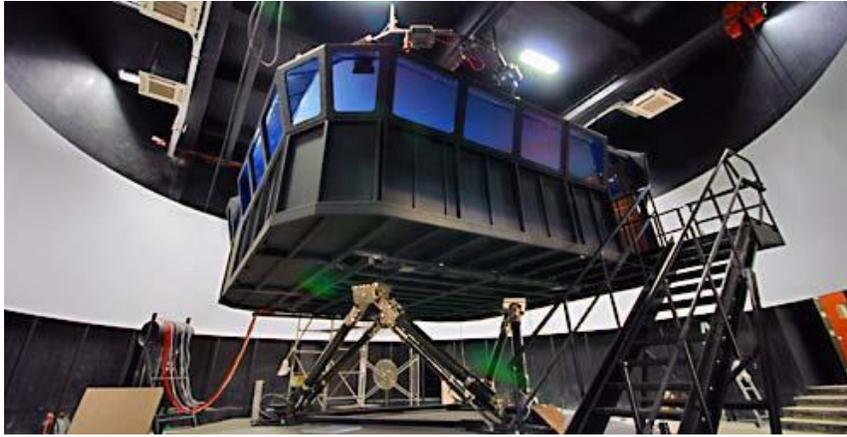
Figura 2: Simulador de navegación con seis grados de libertad (Fuente: González E. 2019)
