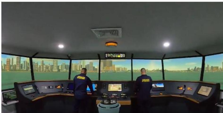
Figura 14: Simulador de Puente Full Mission con 360° de visualización (Fuente: Cidiam 2023)
